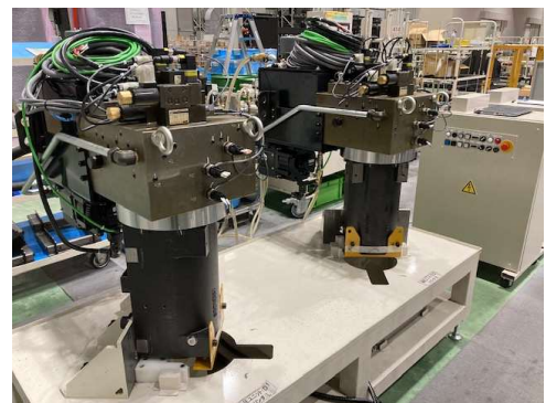
HRB D軸モジュール（油圧装置）エア抜き作業を自動化
