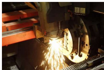
FO-M IIRI3015による角パイプのレーザー加工
