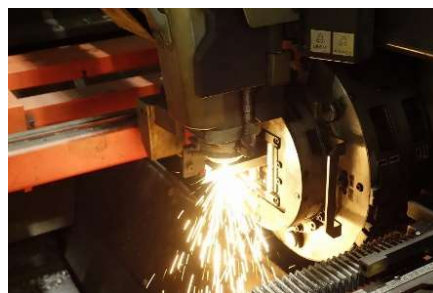
使用FO-MII RI3015进行角形管道加工
