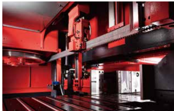
带锯条扭转角度为 0^{\circ} 的新锯削头机构
