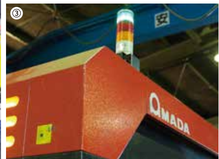
①光纤激光加工机ENSIS-3015AJ以2KW的输出功率可以特别加工16mm以上的厚板 / ②ENSIS-AJ的最新型NC装置AMNC 3I上可以显示1个月的运转记录。 / ③在3台激光加工机上设置了三色灯，可以对机器的运转状态一目了然（运转中・待机中・停止中）
