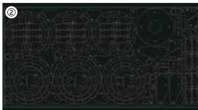
①二氧化碳激光加工机FO-M II 4222NT(4kW)可以对应4x2m·板厚22mm的加工 / ②FO-M II用成套数据。SPH·板厚6mm的5' x 10'材料可以完成配件间无缝隙的切割。
