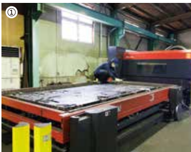
①二氧化碳激光加工机FO-M II 4222NT(4kW)可以对应4x2m·板厚22mm的加工 / ②FO-M II用成套数据。SPH·板厚6mm的5' x 10'材料可以完成配件间无缝隙的切割。
