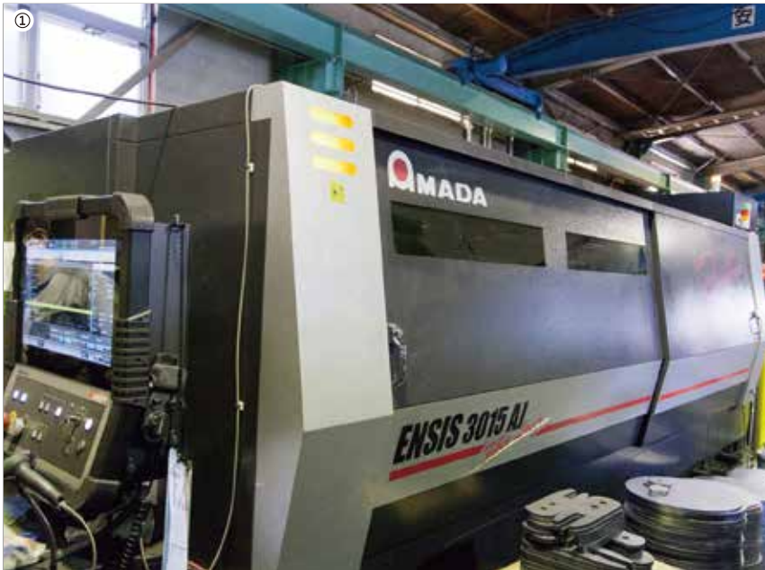
①光纤激光加工机ENSIS-3015AJ以2KW的输出功率可以特别加工16mm以上的厚板 / ②ENSIS-AJ的最新型NC装置AMNC 3I上可以显示1个月的运转记录。 / ③在3台激光加工机上设置了三色灯，可以对机器的运转状态一目了然（运转中・待机中・停止中）
