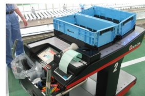
ICチップ内蔵バケットとモニター付きピッキングカート（アマダ・パーツセンター）
