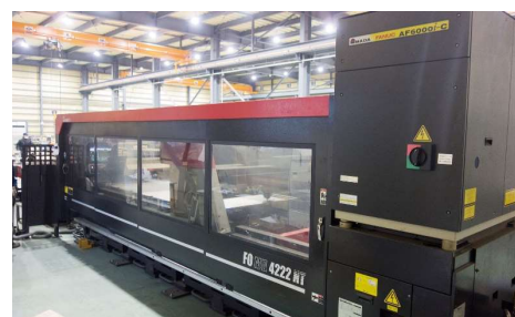
CO 2 レーザマシンFO-MⅡ4222NT（6kW）は厚板加工を中心に行う
