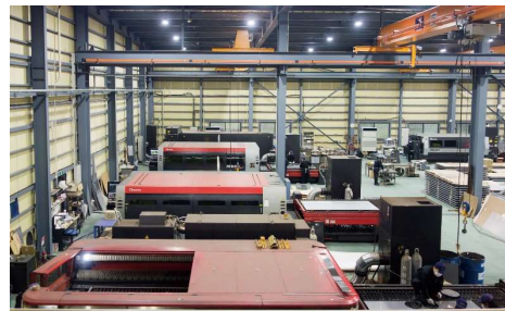
ファイバーレーザマシン3台とCO 2 レーザマシン2台、計5台が並ぶ
