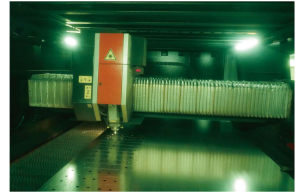
ENSIS-3015AJによる溶融亜鉛メッキ鋼板・4.5mmの加工
