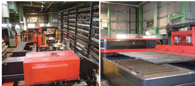
左: 自动仓库MARS 可以与激光加工机2台和冲床1台合计3台联动 右: 激光加工机FOL-3015NT+ LSC-3015FOL + LST-3015FOL
