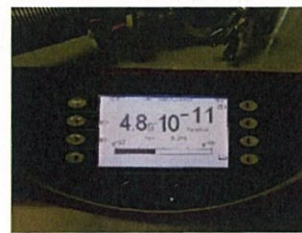
図表 2. 製作した真空チャンバーの検査結果
