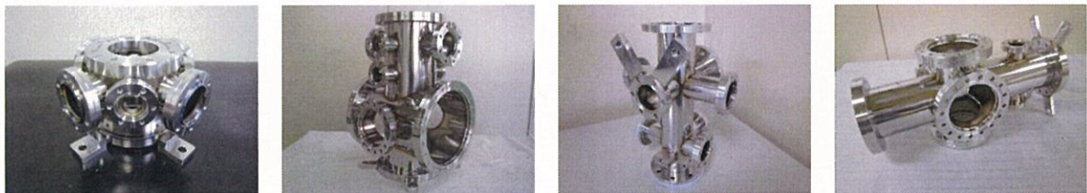
図表 3. これまで製作した真空チャンバーの例
