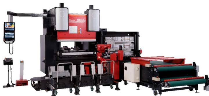
**電動サーボ汎用ベンディング自動化システム「EGB-1303ARse」**
