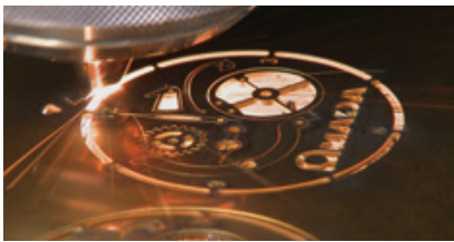
ファイバーレーザマシンによる 銅（高反射材）の加工
