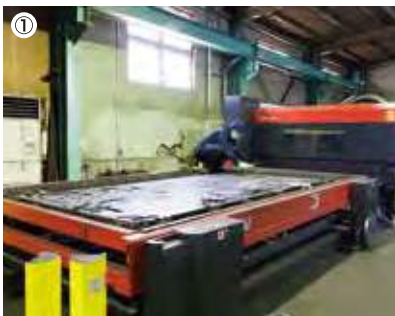
①4×2m・板厚22mmまで対応できるCO 2 レーザーマシン FO-MII4222NT (4kW) / ②FO-MII用のネスティングデータ。SPH・板厚6mmの5'×10'材にパーツ・イン・パーツで隙間なく割り付けられている
