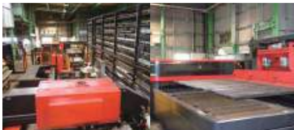
左:自動倉庫MARSにはレーザーマシン2台とパンチングマシン1台の計3台が連動している 右:レーザーマシンFOL-3015NT+LSC-3015FOL+LST-3015FOL
