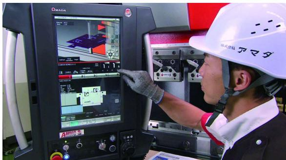
18.5インチの大画面マルチタッチ式LCDパネルを採用し、スマートフォンのような操作性を実現
