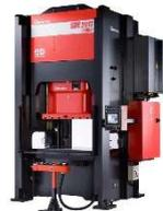
薄い金属の板に金型で加工します。端子などの電子部品、絞り加工の必要な自動車部品などの加工に用います。
