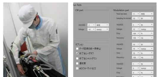
AJ発振器光パルス波形測定作業を自動化
