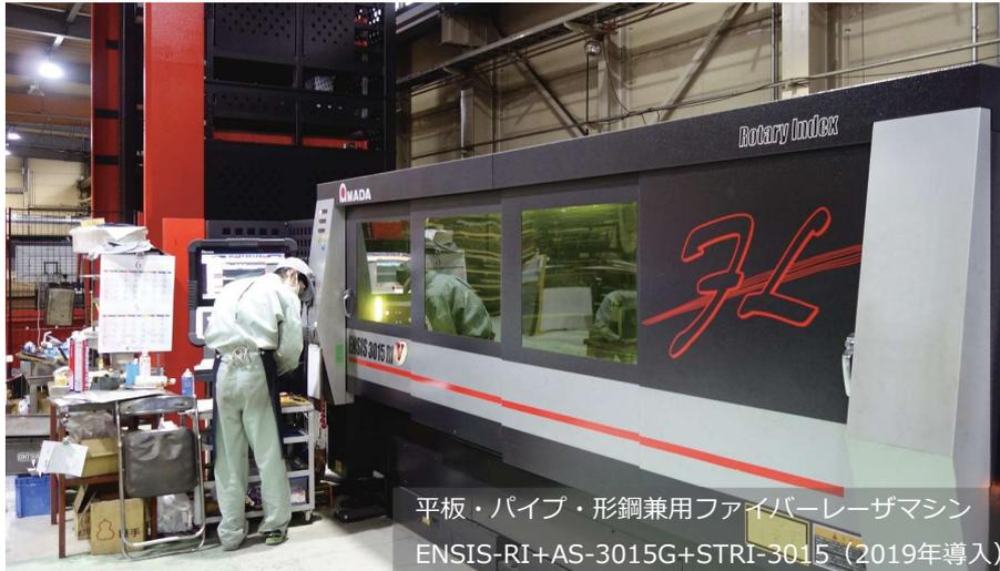
平板・パイプ・形鋼兼用ファイバーレーザーマシン
