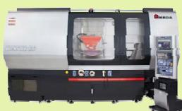
をコンセプトに開発し、このクラスでは一般的なテーブル左右駆動をNCサーボ化することで油圧装置を廃し、といし軸上下・前後、テーブル左右の3軸NC制御による新たな高速・高機能成型加工を実現するとともに、積算消費電力量従来比70%削減、廃油処理削減を実現しました。
