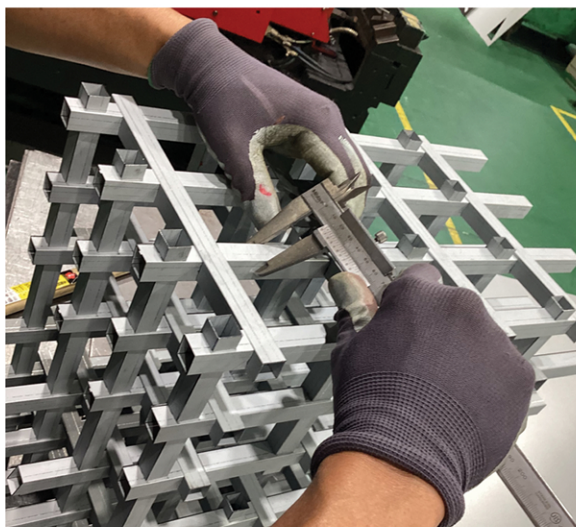
⑥ 少しでもゆがむと柱のパーツすべてがうまく噛み合わなくなるので誤差無きよう組み立てます。溶接もビスも使わず「曲げ」のみの組み立てなので分解してまたパーツに戻す事も可能です。
