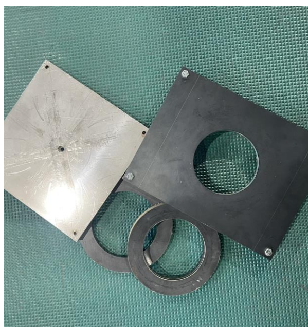
ダイ・治具の一部 (レーザー加工機で製作)
