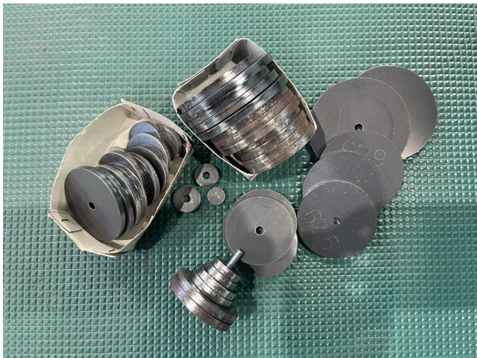
ディスクの一部 (レーザー加工機で製作)
