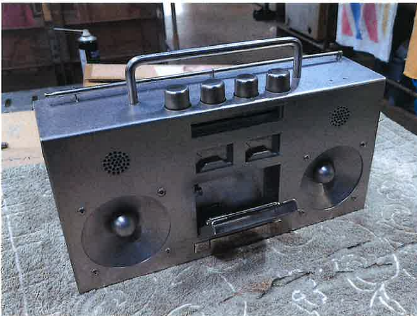
左端のスイッチを押すとカセット部分が開き、閉める時は手で行います。
