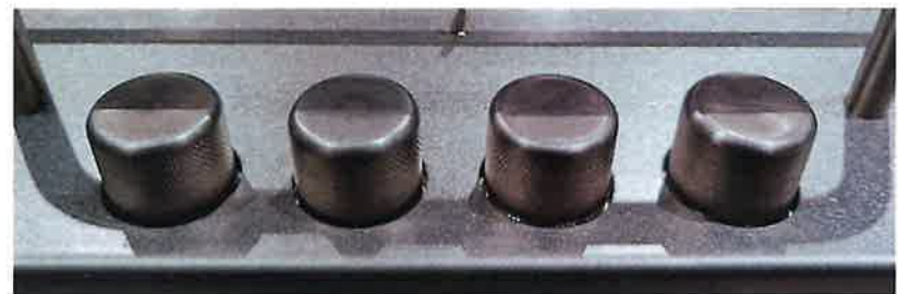
ボリューム等のツマミはパイプにエンドキャップを溶接して仕上げ、その後ローレット加工しています。
