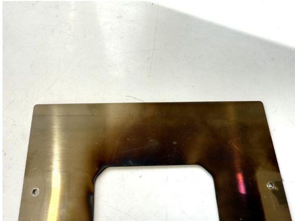
SUS304材：羽釜1合炊飯後の 外観（変色多い）
