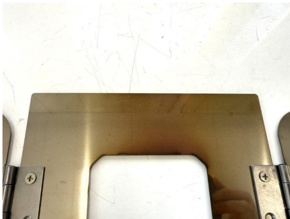
SUS430材：羽釜1合炊飯後の 外観（変色少ない）
