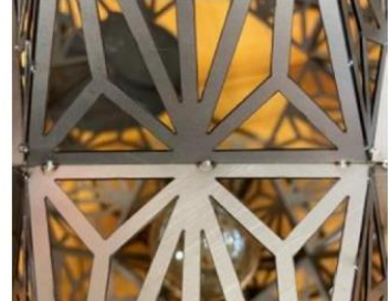
図 11 成功した溶接結果 (焼け少なく溶接部が銀色)
