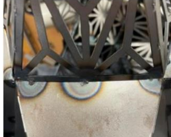
図 10 失敗した溶接結果 (溶接による焼け・歪み)
