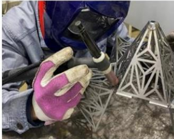
図 9 TIG 溶接作業の様子
