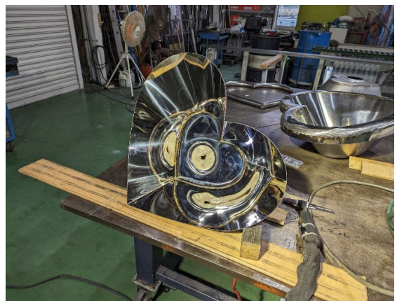
排水をプレスした底面を溶接
