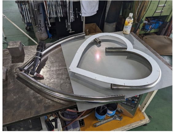
丸パイプを曲げてR20のハートゲージを作成
