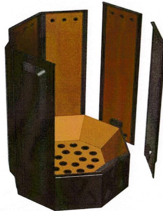
パネル下部の三角の突起をベース側面の穴に差し込んで取り付けてください。
