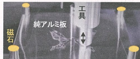
図 2 材料(A1050)の取り付け方法
