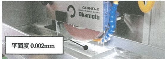
図3 平面研削盤でのトラバース加工の様子
