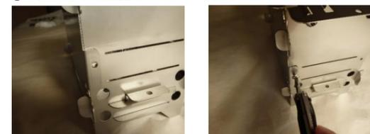
⑦上部焼き面の溝に鉄久（丸棒）をセットします。通常1本（串先端 肉側）で使用、串部分は手前折返しに乗せることで串の焦げを軽減します。串が短いなど、状況に合わせて位置、本数を調整してください。
