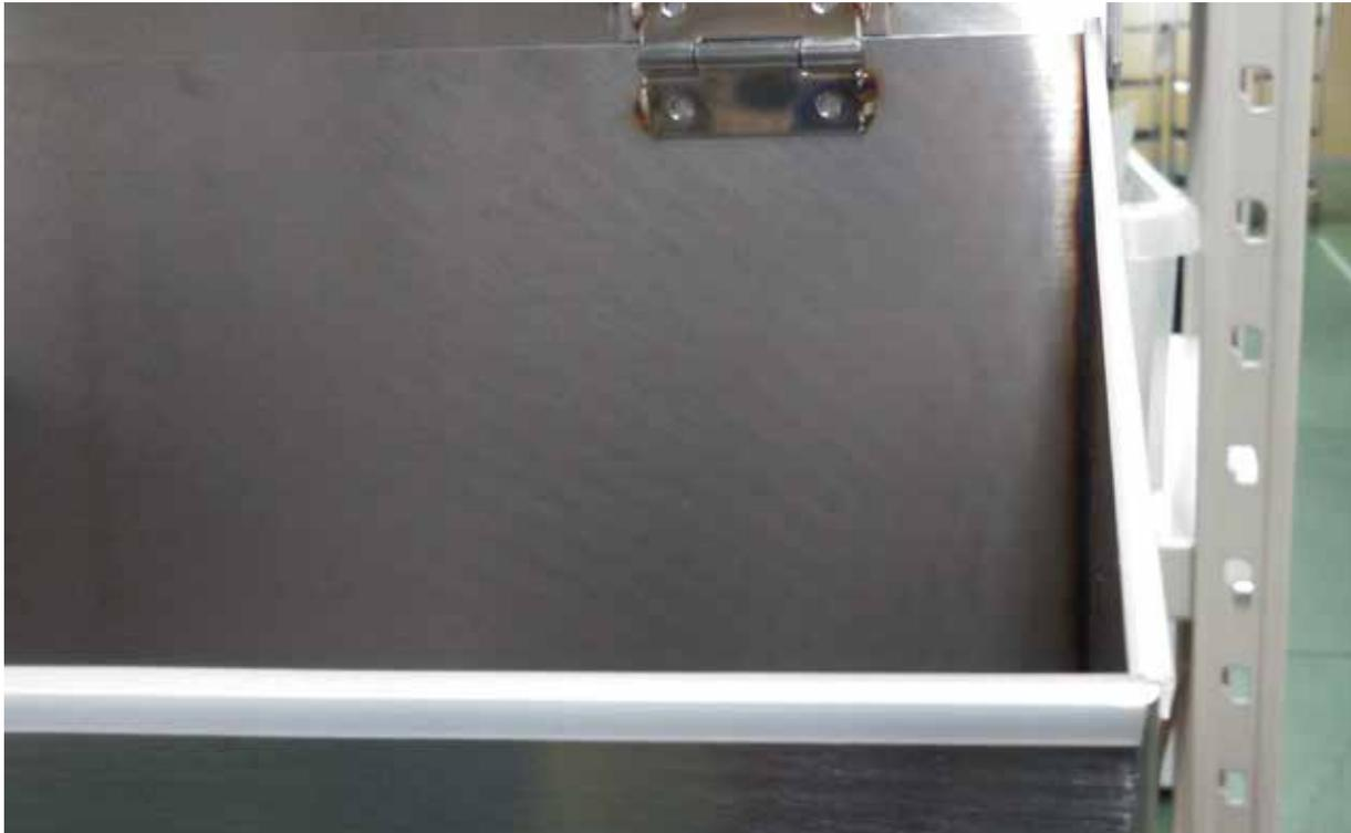
蓋と本体の接触部分、ならびに、スリット部の下部には、エッジプロテクタを用いて保護を行い、金属同士の耳に障るような甲高い接触音の発生を抑えるようにしています。
