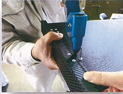
リベットによる蝶番取付け
