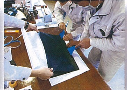
カーボン調シート貼付け
