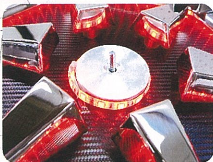
LED 間接照明 (中心及び外周)
